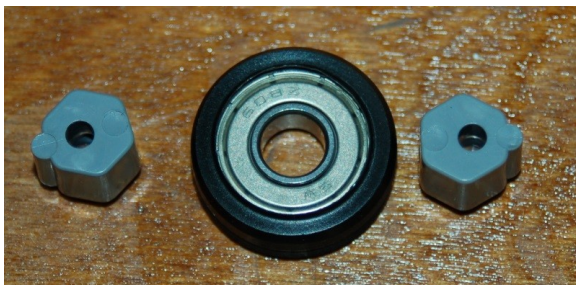
Fig. 8-20:Eccentric spacers & roller.
